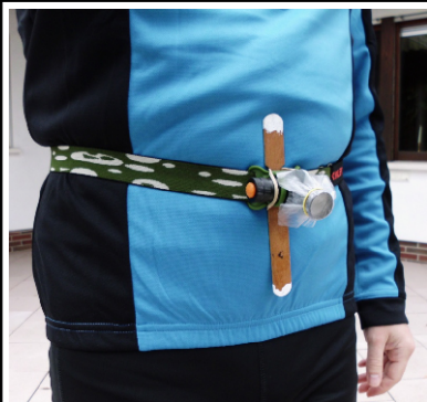
Zur Bauchlampe umgebaute Stirnlampe mit Streufolie.
